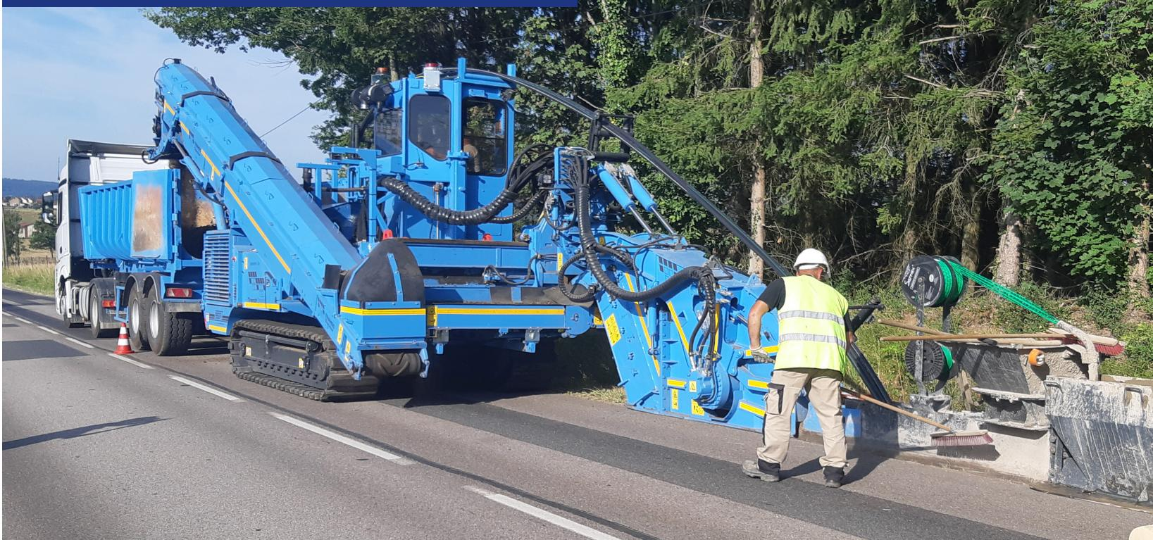
La Tesmec 950R R620 est une trancheuse de 25 tonnes dotée d'un moteur de 275 ch (205 kW) et conçue pour les réseaux de fibres optiques en milieux urbains
