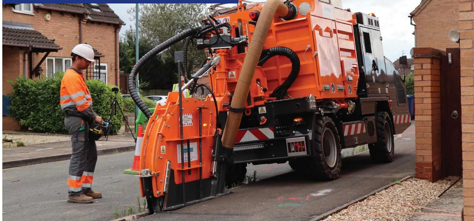
La CityCleanfast Tesmec est une tracheuse de 10 tonnes dotée d'un moteur de 142 ch (105 kW) conçue pour un déploiement rapide et propre des réseaux de fibre optique dans les zones urbaines.
