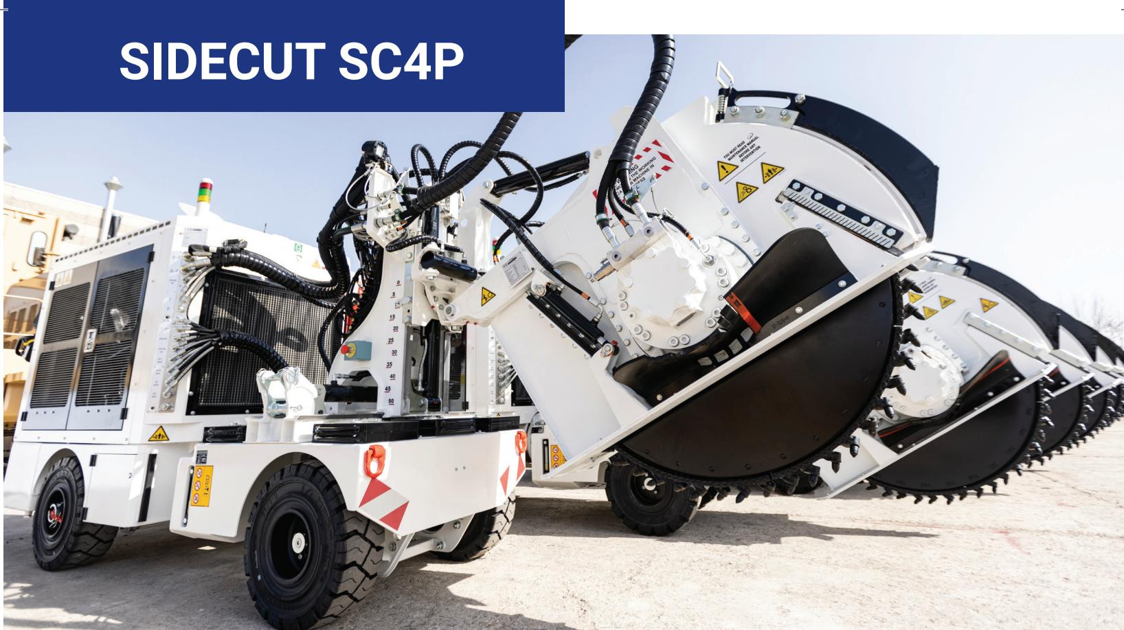
Le SC4P Tesmec est une trancheuse de 3 tonnes dotée d'un moteur Stage V de 74 ch (55 kW) ou 73 ch (54 kW) conçue pour le déploiement de réseaux de fibre optique dans les zones urbaines.
