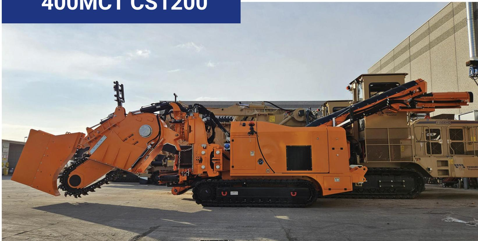
La Tesmec 400MCT CS1200 est une trancheuse à chaîne de 13 tonnes, dotée d'un moteur Tier 4 de 238 ch (175 kW) ou Tier 3 de 218 ch (160 kW), et conçue pour les travaux de réseaux télécom et d'énergie en milieux urbains et extra-urbains.
