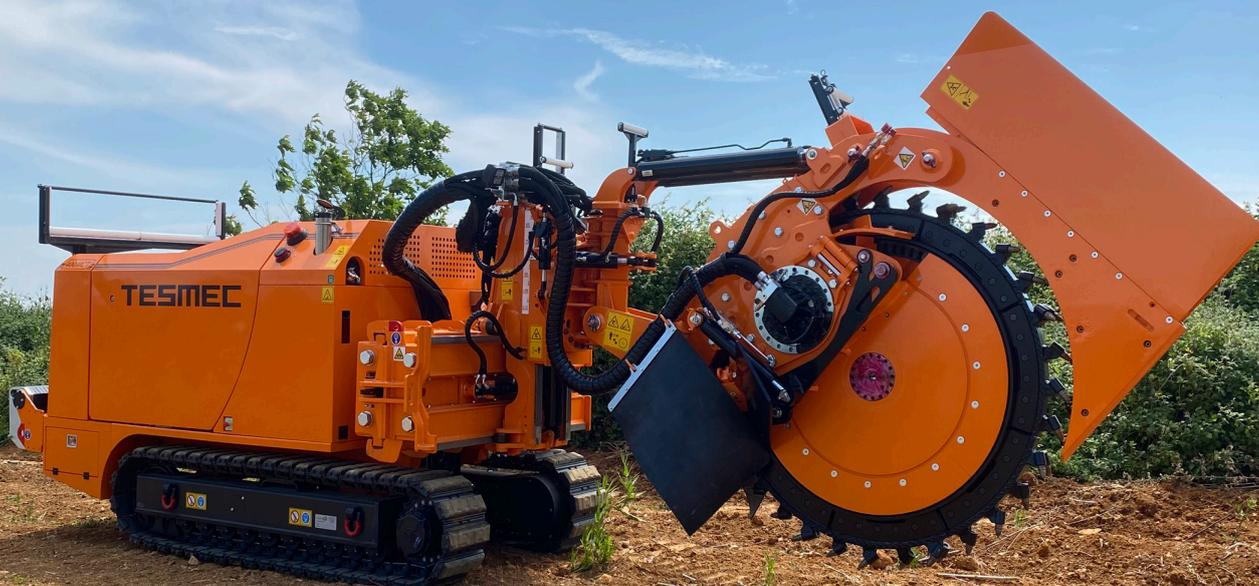
La Tesmec 400MCT RT1100 est une trancheuse à roue de 14 tonnes, dotée d'un moteur Tier 4/Stage V de 238 ch (175 kW) ou Tier 3 de 218 ch (160 kW), et conçue pour les travaux de réseaux télécom et fibre optique en milieu urbain.
