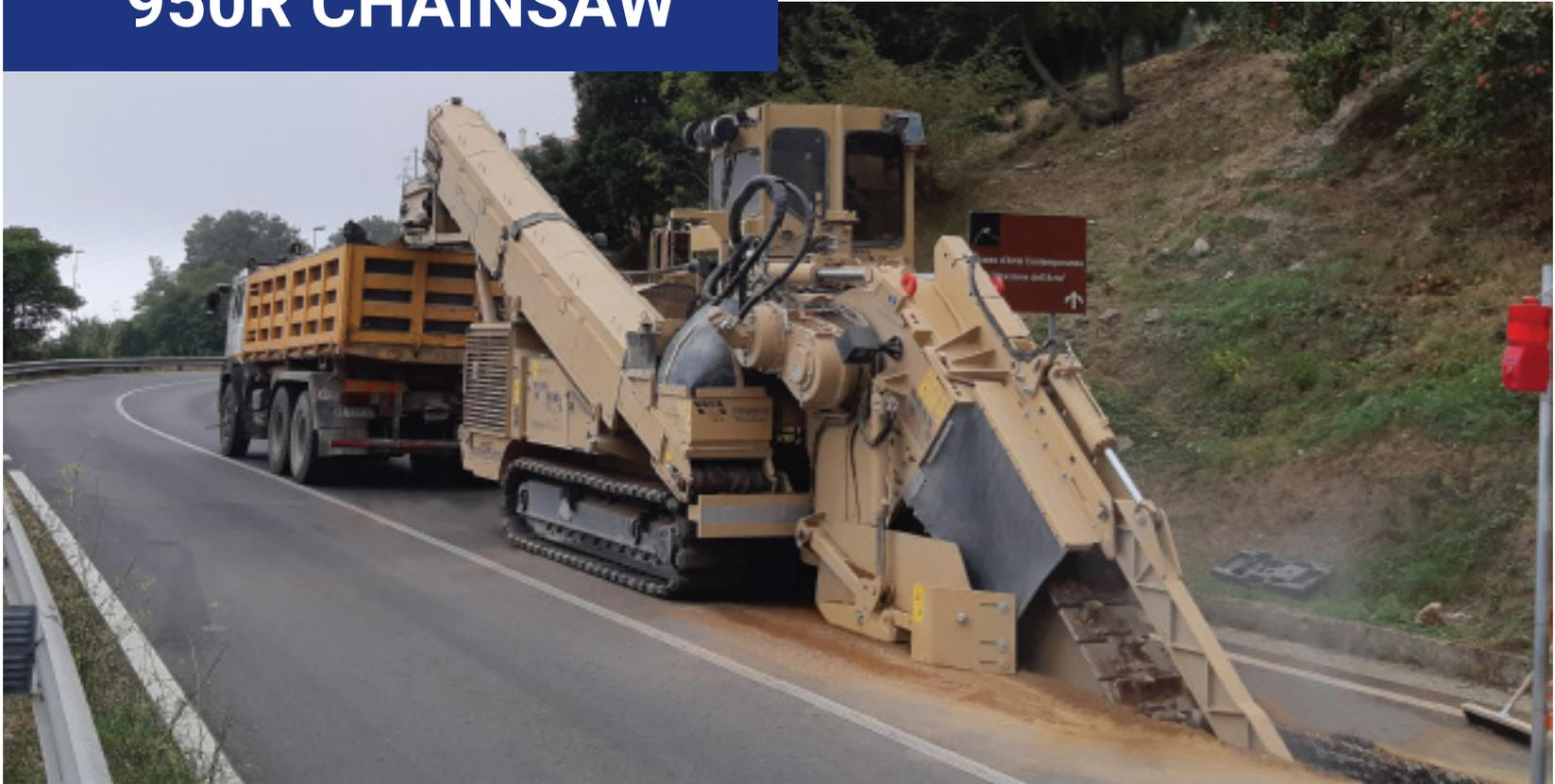
La Tesmec 950R Chaîne est une trancheuse de 25 tonnes dotée d'un moteur de 275 ch (205 kW) et conçue pour les réseaux urbains et souterrains: télécom, électricité, gaz, eau et égouts.
