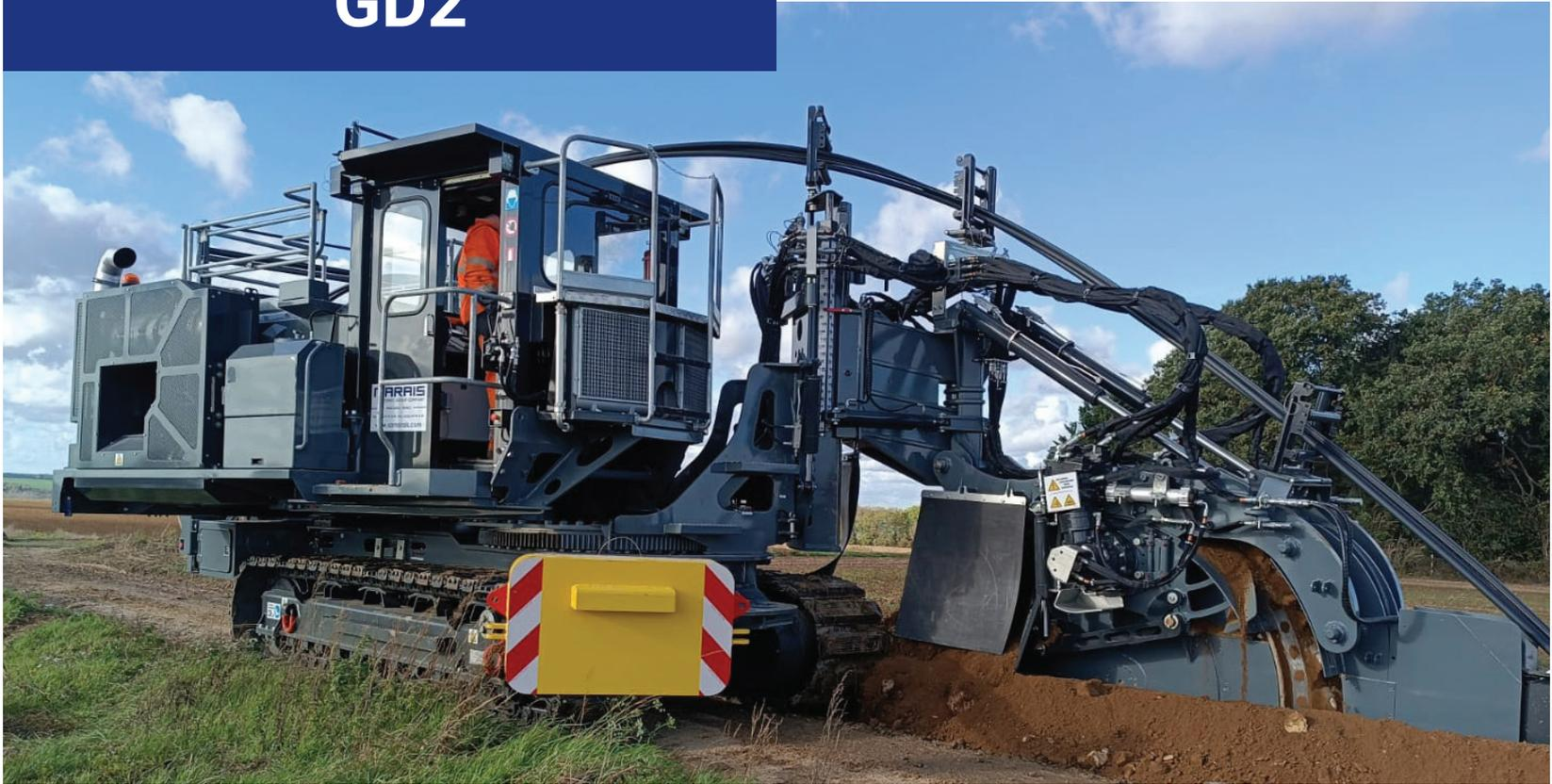
La GD2 Tesmec est une trancheuse de 25-27 tonnes dotée d'un moteur de 510 ch (375 kW) conçue pour réaliser simultanément l'ouverture et la pose mécanisée de réseaux dans des environnements ruraux et rocheux
