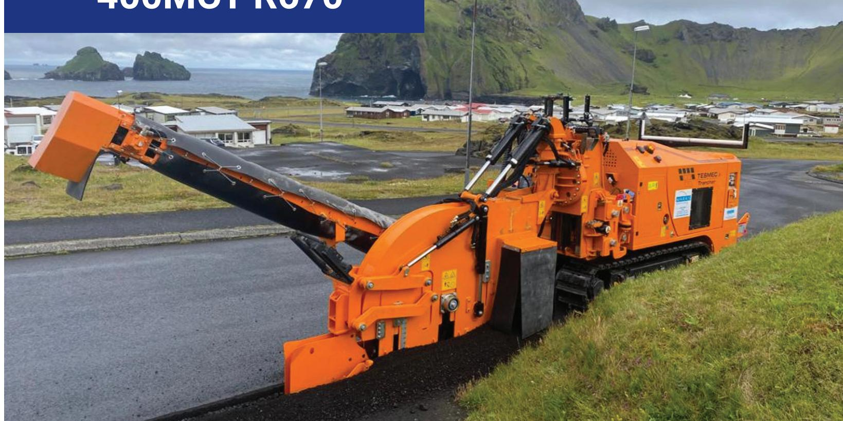
La Tesmec 400MCT R670 est une tracheuse à roue de 11 tonnes, dotée d'un moteur Tier 4/Stage V de 238 ch (175 kW) ou Tier 3 de 218 ch (160 kW), et conçue pour les travaux de réseaux télécom et fibre optique en milieu urbain.
