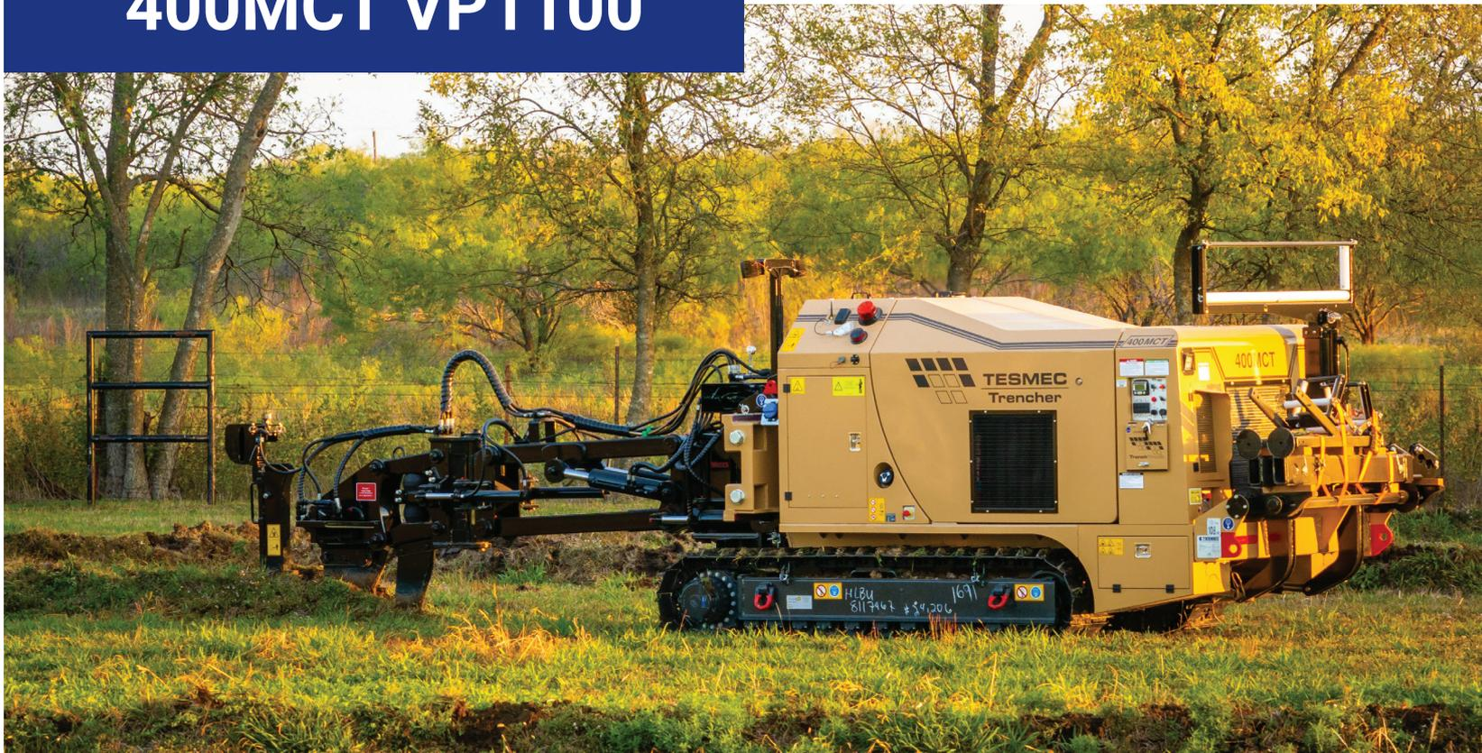
La Tesmec 400MCT avec l'outil sous soleur vibrant VP1100 est une trancheuse de 10 tonnes dotée d'un moteur Tier 4/Stage V de 238 ch (175 kW) ou Tier 3 de 218 ch (160 kW) ; elle est conçue pour les travaux de réseaux télécom et d'énergie en milieu rural.
