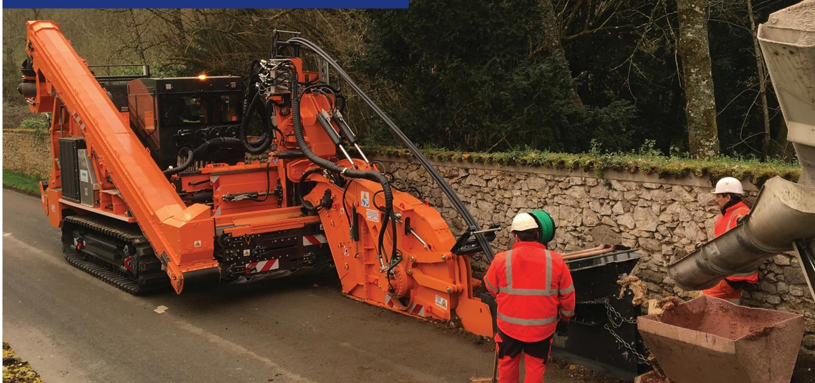
La MTR430 R620 est une trancheuse Tesmec de 30 tonnes dotée d'un moteur de 428 ch (315 kW) conçue pour optimiser la pose mécanisée de réseaux en milieux ruraux et urbains.
