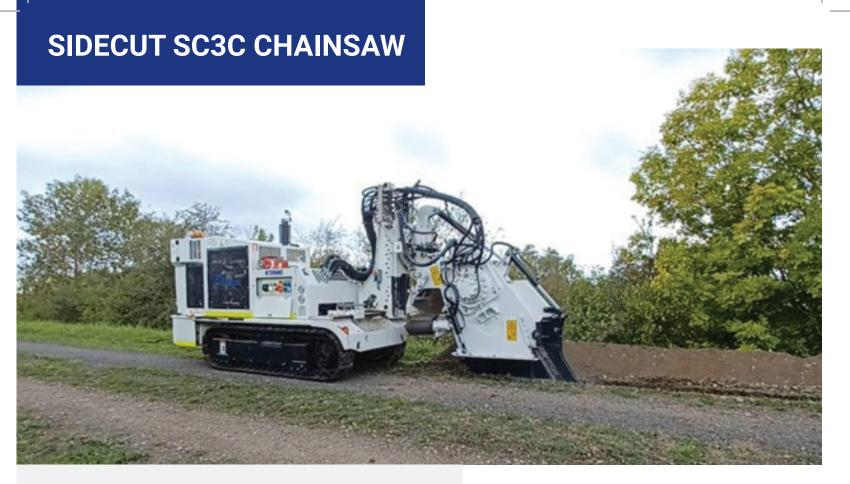
Le SC3C Tesmec est une trancheuse de 4 tonnes dotée d'un moteur de 98,7 ch (73,6 kW) conçue pour le déploiement de réseaux de fibre optique dans les zones urbaines.
