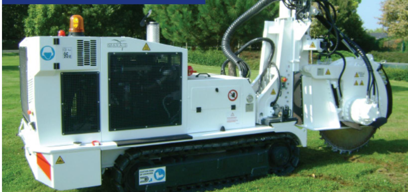
Le SC3C Tesmec est une trancheuse de 4 tonnes dotée d'un moteur de 98,7 ch (73,6 kW) conçue pour le déploiement de réseaux de fibre optique dans les zones urbaines.
