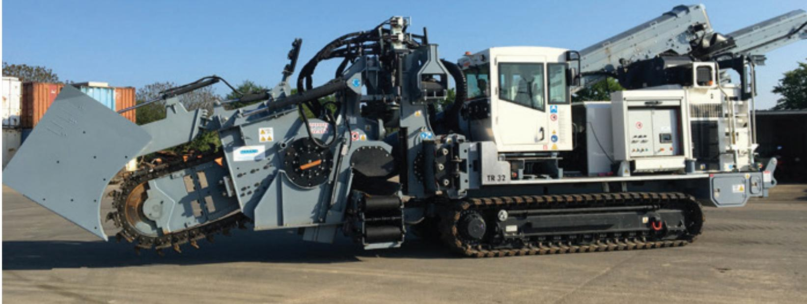
La MTR430 CS1300 est une trancheuse Tesmec de 33 tonnes dotée d'un moteur de 428 ch (315 kW) conçue pour optimiser la pose mécanisée de réseaux en milieux ruraux et urbains.
