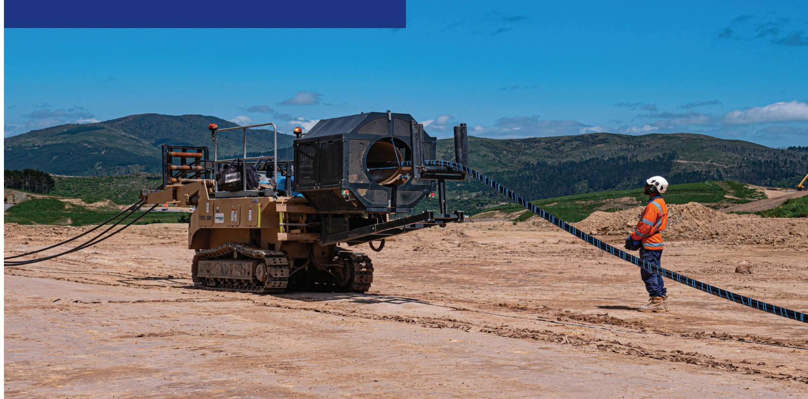
La Ligatureuse Tesmec 300 est une machine de 6 tonnes dotée d'un moteur Tier 4 de 73 ch (54,5 kW) et conçue pour regrouper des câbles ou des fourreaux PEHD en trèfle pour faciliter les travaux d'installation de câbles d'énergie et/ou telecom.
